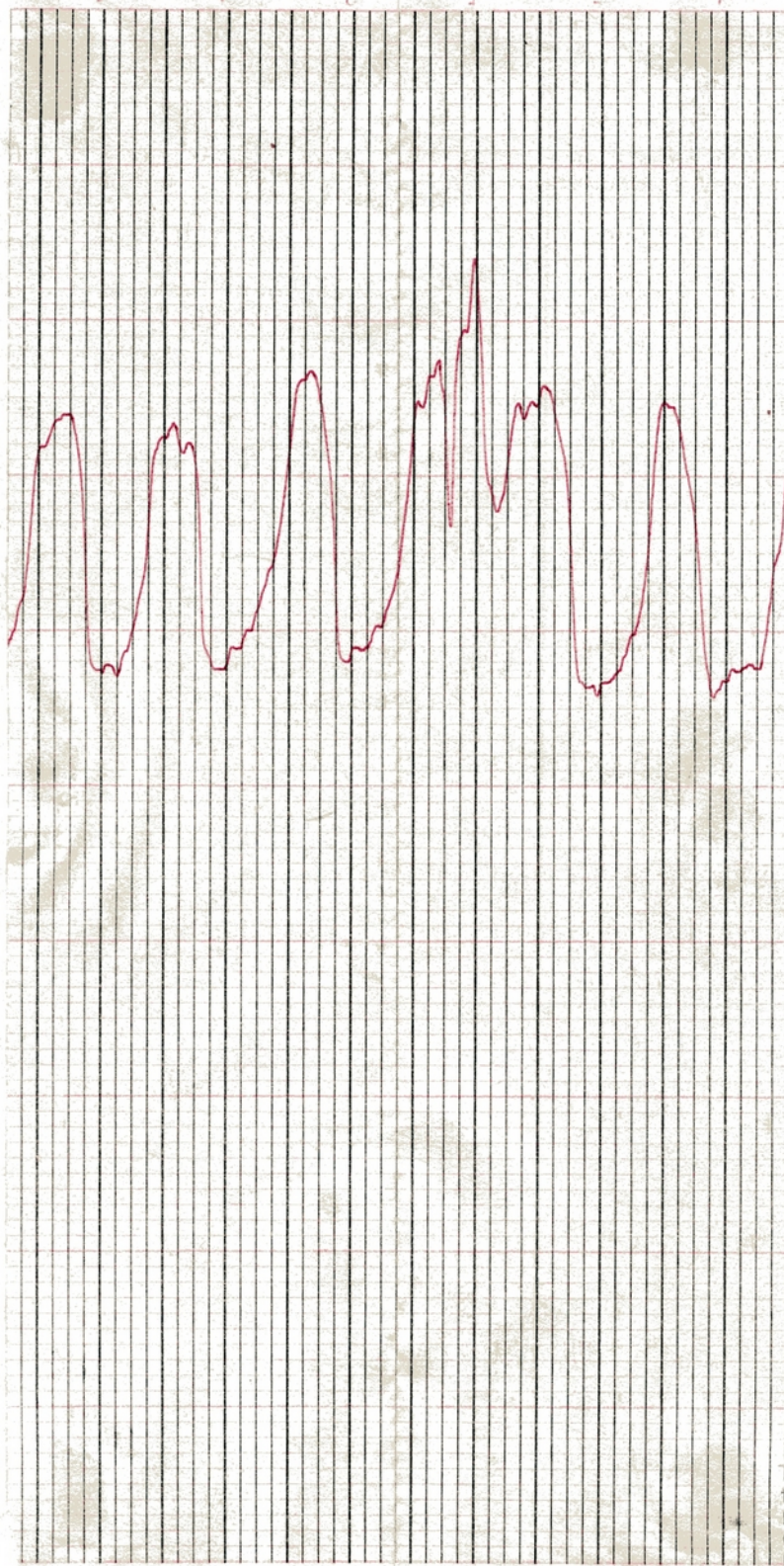
Рис. 34: Диаграмма годовичных колец, получаемая с помощью анализатора слоистых структур
